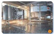
Double impingement crust freezing fan unit
